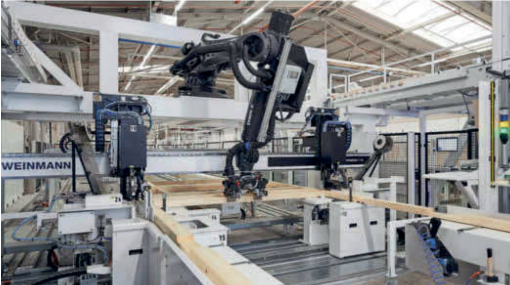
Vollautomatisierte Fertigung bei Weberhaus: Ein Roboterarm legt Hölzer für Wände in Position. Ab Sommer unterstützen weitere Roboter bei den nächsten Schritten der Hausfertigung.
