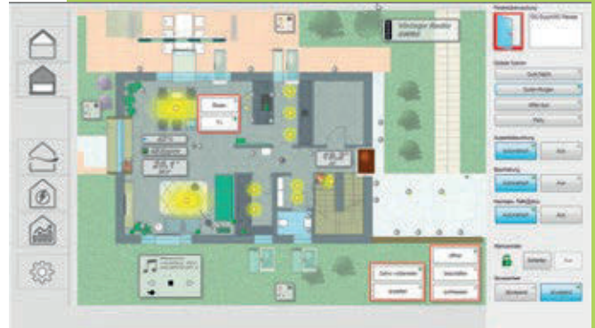
Aufsicht: Alltägliche Funktionen wie Licht, Musikwiedergabe und Raumtemperatur der verschiedenen Zimmer zeigt die Myhomecontrol-Oberfläche auf einer übersichtlichen Grundrissdarstellung an. Per Fingertippen lassen sich die Funktionen aktivieren.
